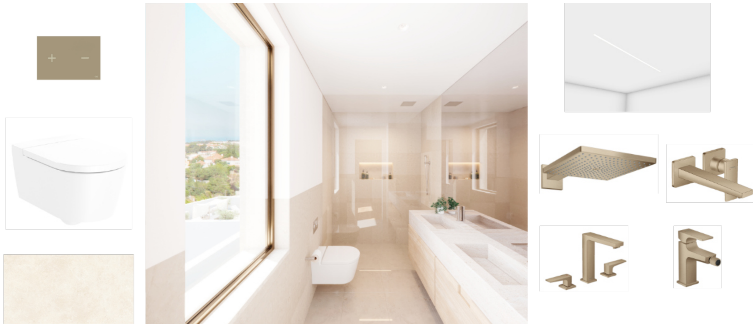
Casas de banho com parede na cor branco areia, pavimento e paredes do duche em porcelânico Margres série Concept cor Beige, acabamento ASR, tecto na cor branco com iluminação embutida em branco, loiças sanitárias Roca serie Rimless na cor branco e Placa de comando Oli serie Glassy, torneiras Hansgrohe em brushed bronze e aralehagem elétrica na cor areia
